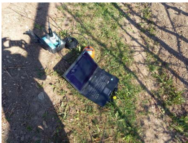
Foto 12: stazione HVSR in fase di installazione.
